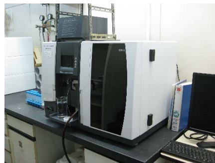
写真2. 原子吸光度計 食塩相当量(ナトリウム)の分析に用いる。
