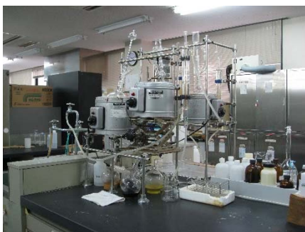
写真1. 蒸留装置 たんぱく質の定量に用いる。
